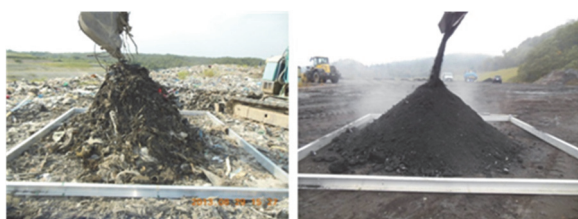
図3 安息角試験 左：中部-3，右：東北-5(燃え殻)
